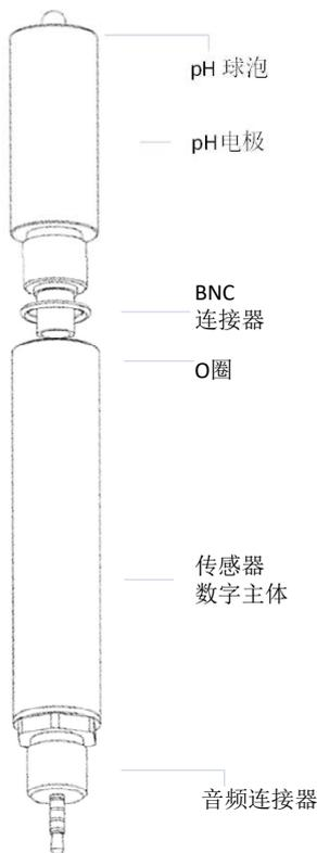
蛙视数字pH/ORP传感器内置模数转换及信号隔离功能，采用可现场更换的配有毛细液接耐用的参比电极的pH和ORP电化学电极。适用于复杂现场以及PLC等工控上位机现场使用。
